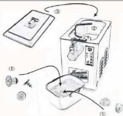
1 - Faites tremper la douille et le régulateur d'air (démontés) dans le reste du mélange toute la nuit.
